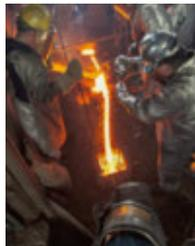
**Genau wie früher.** In Passau ist die einzige historische Glockengießerei Bayerns angesiedelt. Hier wird noch im Lehmformverfahren gearbeitet – was nicht nur Kraft, sondern auch Fingerspitzengefühl erfordert. Die aus Lehm gebrannten Glockenformen werden in die Erde eingegraben, dann ergießt sich der glühend heiße Strahl aus Kupfer und Zinn hinein.
